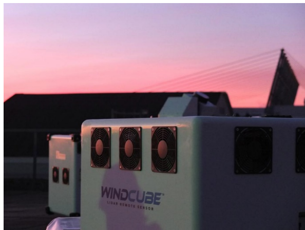
Vindmåling ved hjelp av lidar på Stavanger lufthavn, Sola under LIMECS kampanjen i 2013. Foto: UiB
